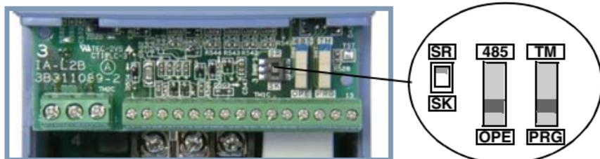
**Note :** Lorsque vous recevez un variateur de type -LFU (c'est-à-dire que la fin de la référence sur la plaque signalétique se termine par LFU), pour utiliser le bornier commande du variateur vous devez changer le Switch SR/SK de position, il faut le passer de la position SK (Etats-Unis, logique négative) à la position SR (Europe, logique positive).
